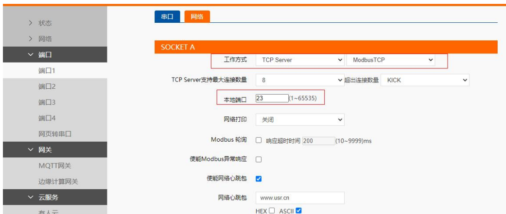
图 61 Modbus RTU 转 Modbus TCP
