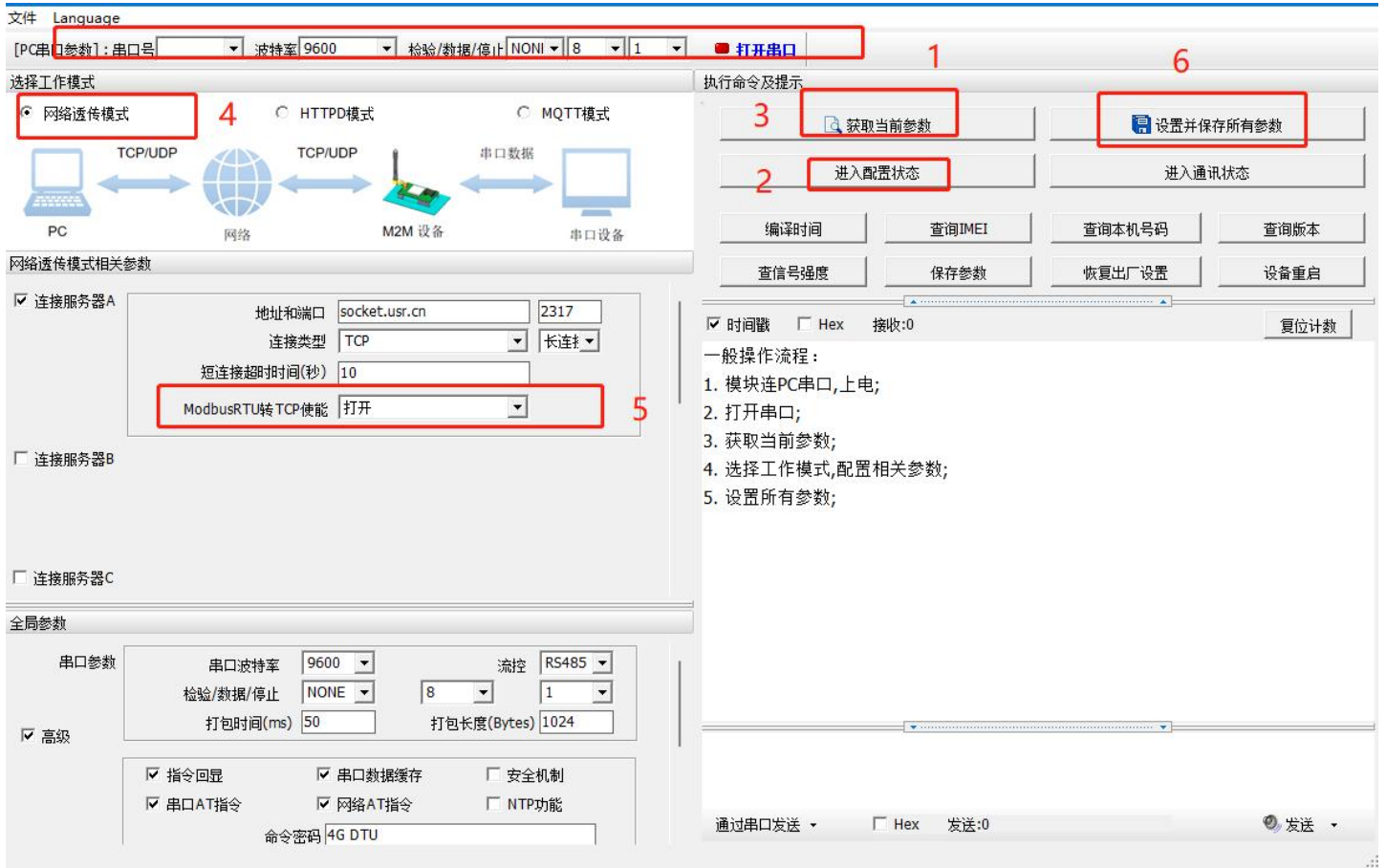
图 24. Modbus RTU 转 Modbus TCP
