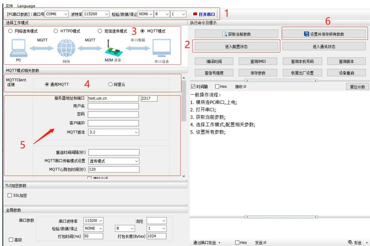
图 5. 设置软件 MQTT 模式示意图
