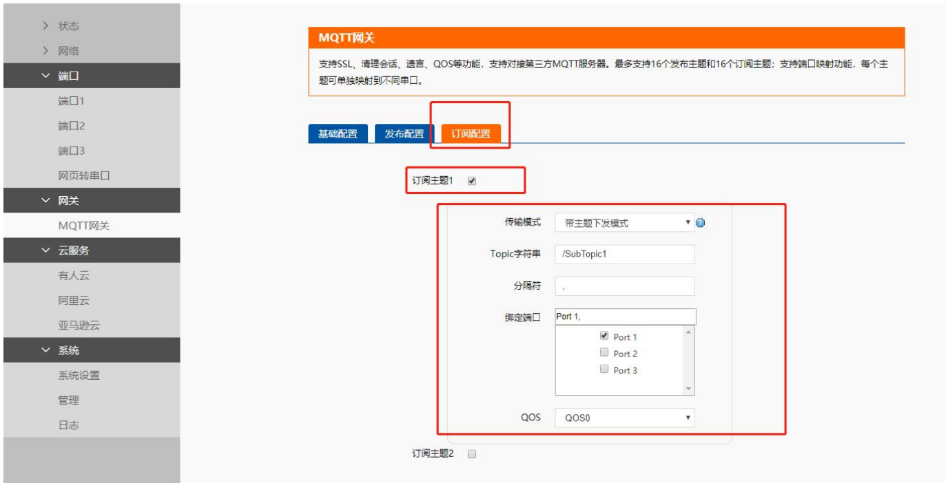
图 105 带主题下发模式参数配置
