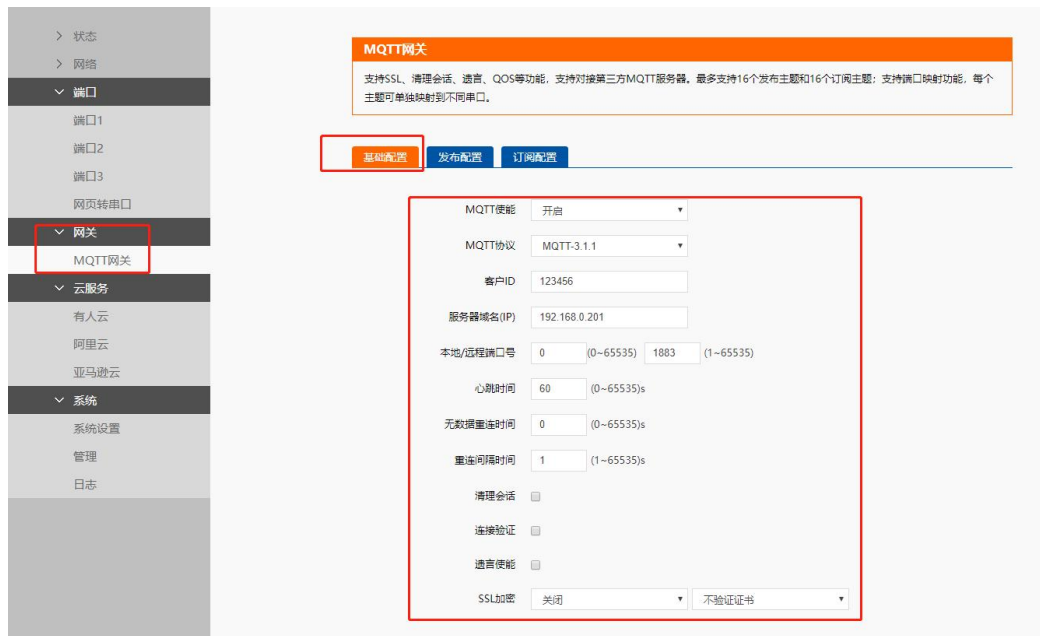
图 95 MQTT 基础参数配置
