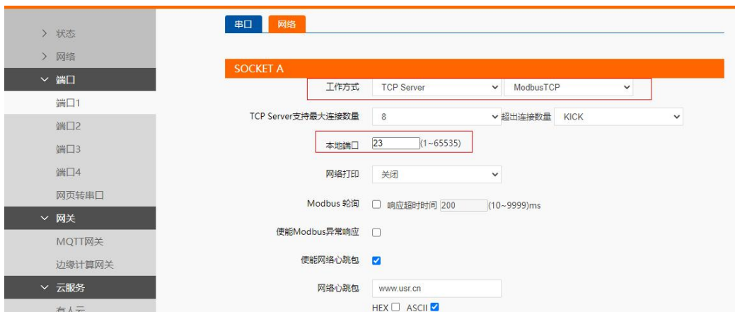
图 61 Modbus RTU 转 Modbus TCP
