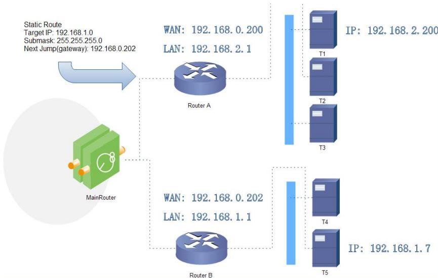
路由器 A 和 B 的 WAN 口都接在 192.168.0.0 的网络内，路由器 A 的 LAN 口为 192.168.2.0 子网，路由器 B 的 LAN 为 192.168.1.0 子网，现在，如果我们要在路由器 A 上做一条路由，使我们访问 192.168.1.x 地址时，自动转给路由器 B。因为是要转给所有 192.168.1.x 网段，所以在添加路由的时候，子网掩码设置为 255.255.255.0，如果目标 IP 设置成固定的 IP 地址，比如 192.168.1.7，则子网掩码要设置成 255.255.255.255。
