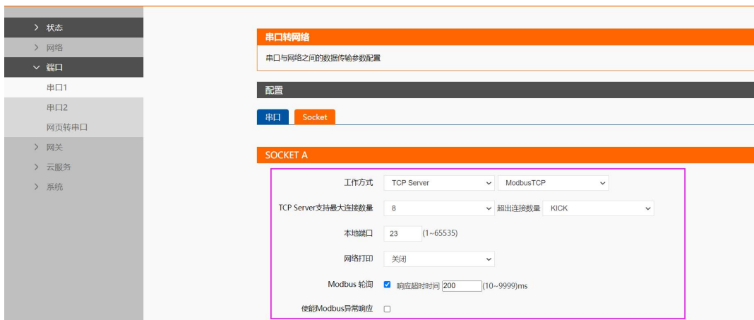
图 22. Modbus 协议转换配置界面
