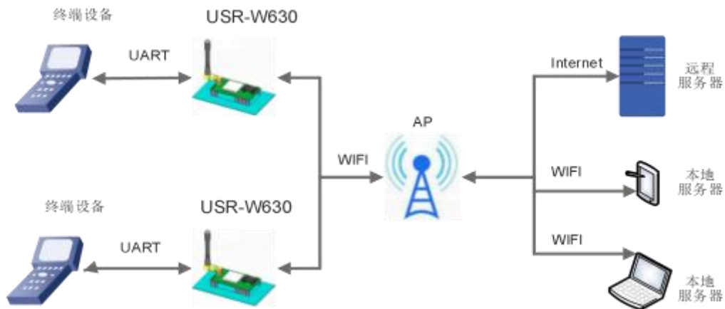
图 8 串口服务器作为 STA 的应用场景
