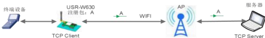
图 16 首次连接发送注册包框图
