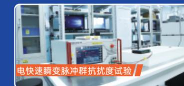
电快速瞬变脉冲群抗扰度试验
