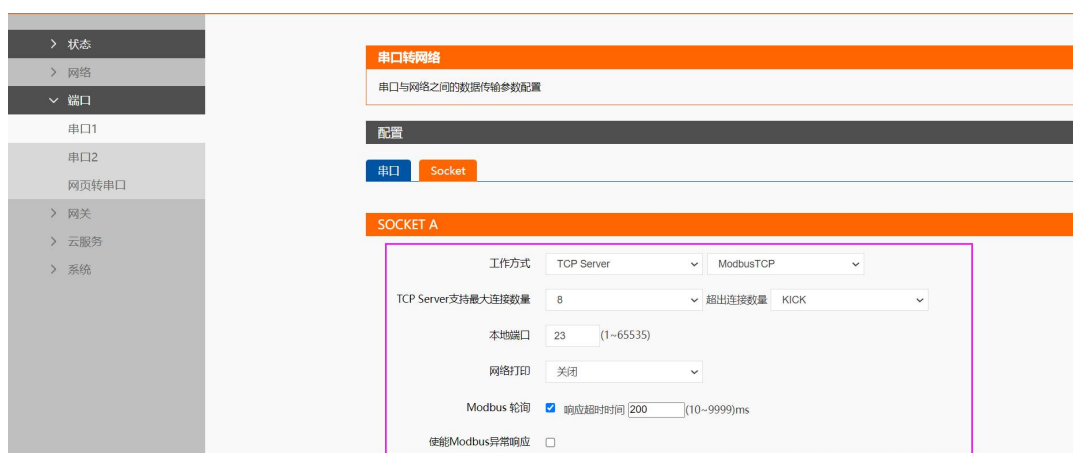
图 22. Modbus 协议转换配置界面
