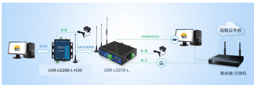
图 4-1 硬件连接示意图
