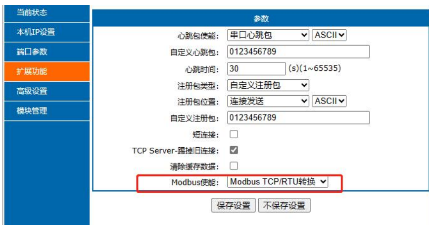
图 43 Modbus RTU 转 Modbus TCP
