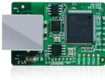
USR-TCP232-E2 是有人物联网推出的一款双串口TTL 模块，采用Cortex-M7 方案，主频高达 400MHz，性能更强，传输速度更快，可靠性更高。支持双串口同时工作，搭载深度优化的 TCP/IP 协议栈。双重看门狗和多种保活机制助力设备稳定运行。支持 TCP Client、TCP Server、UDP Client、UDP Server、Httpd Client 五种工作模式，简单配置即可实现数据透传功能。
