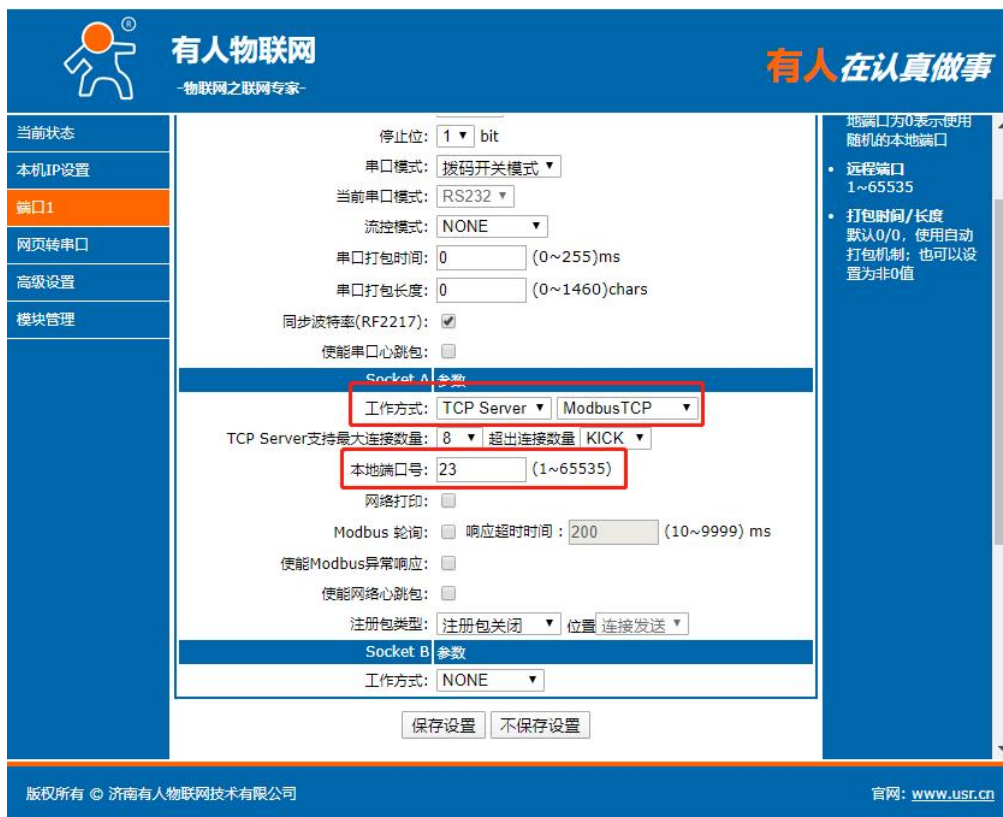
图 44 Modbus RTU 转 Modbus TCP
