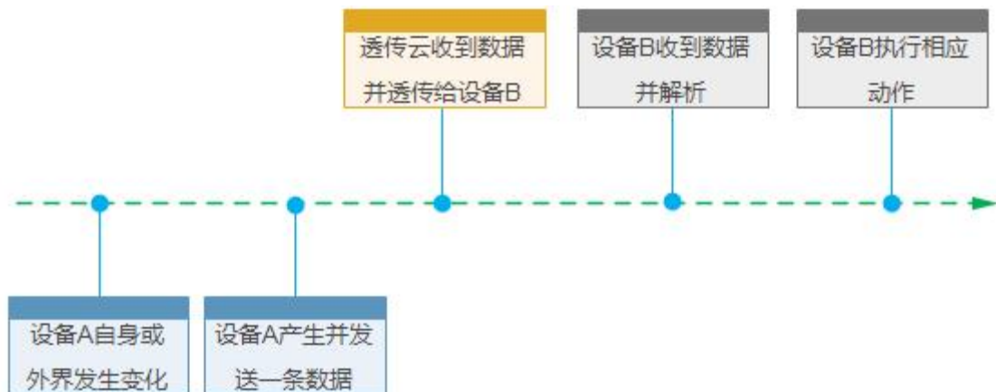
图 20 数据转发流程
