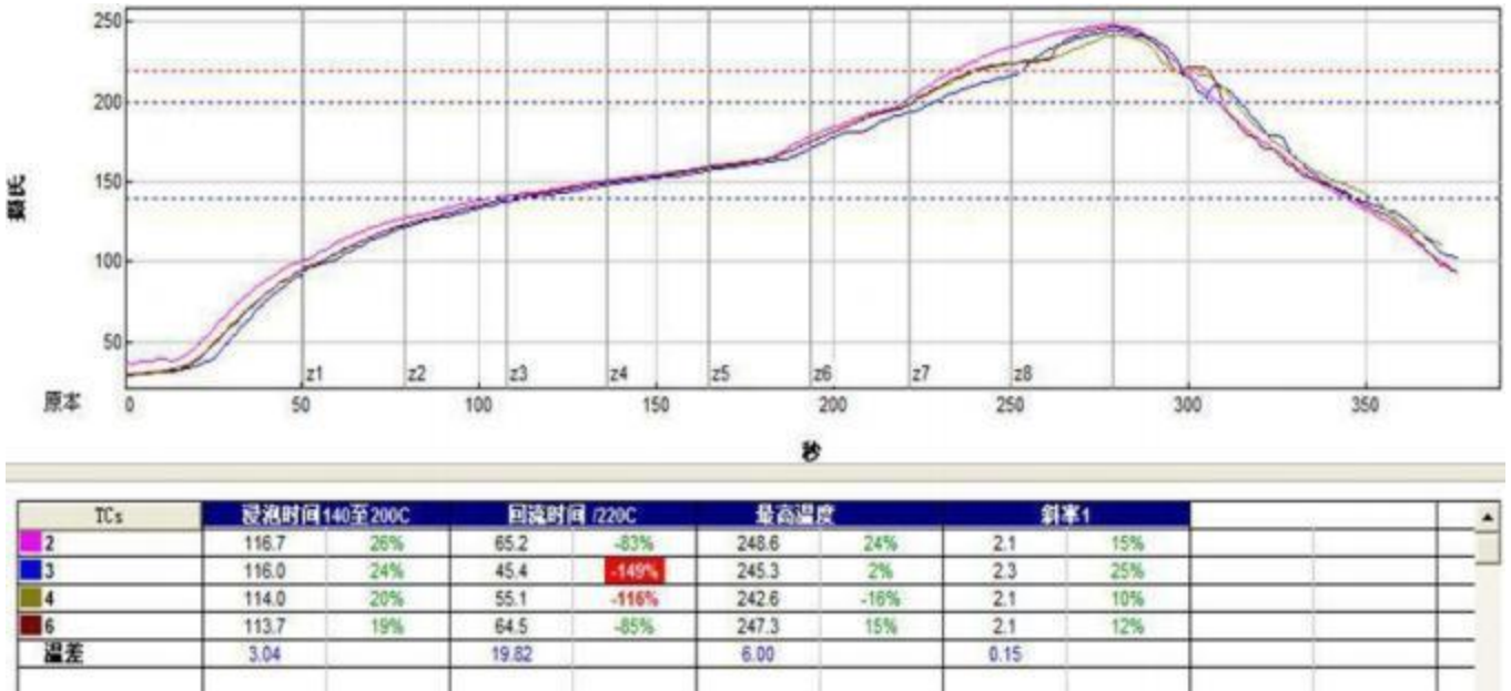
图片14 回流焊焊接温度曲线图
