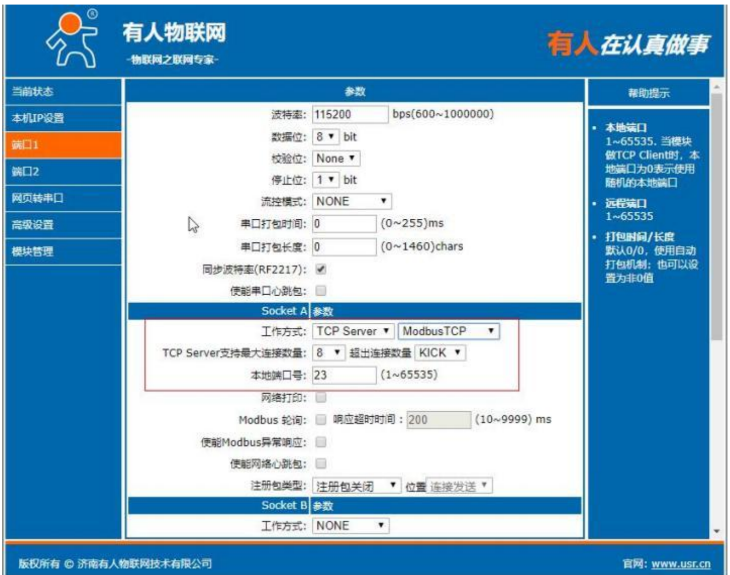
图 41 Modbusrtu 转 Modbus tcp
