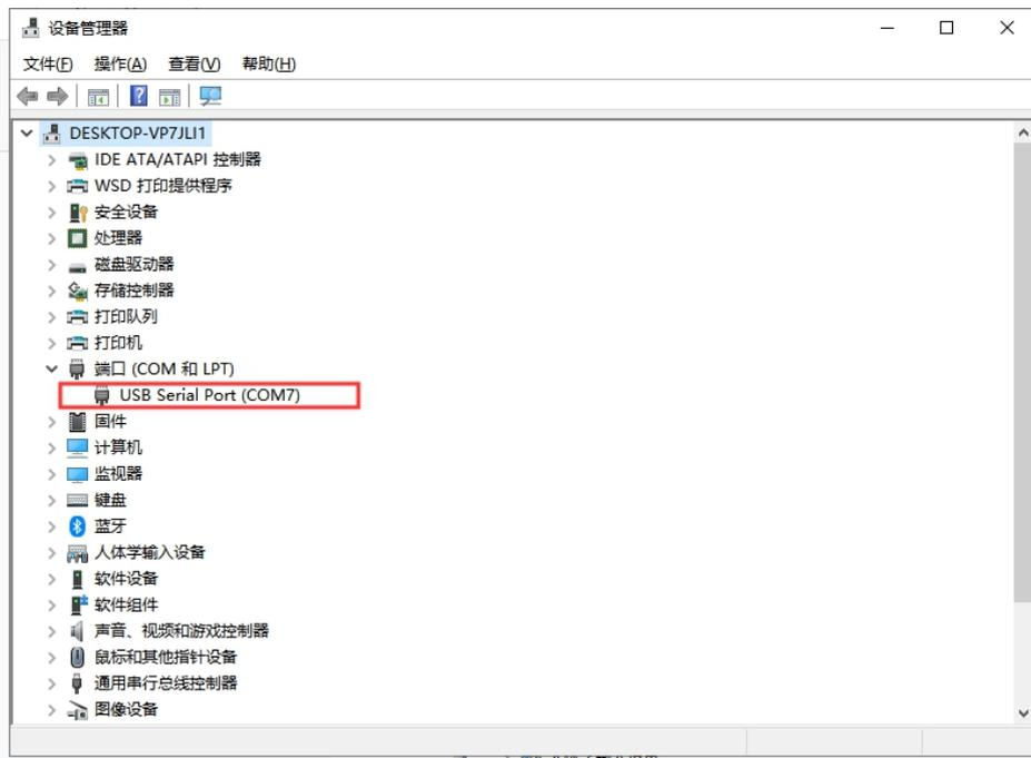
(2) 如下，打开串口，波特率等串口参数出厂默认是：115200, n, 8, 1，点击进入配置状态，返回 OK 则表示成功进入配置状态。
