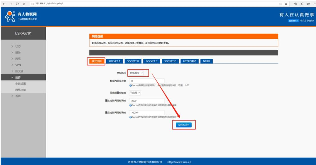
(5) 选择 SOCKET A, 启用, 设置地址和端口为 test.usr.cn, 2317, 保存并应用
