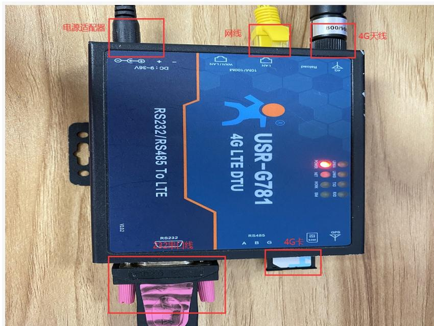
供电：USR-781 工作电压为 DC9~36V，建议配套使用出厂提供的 DC 12V/1A 电源适配器
