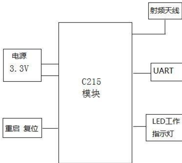
图 4 USR-C215 模块硬件框图
