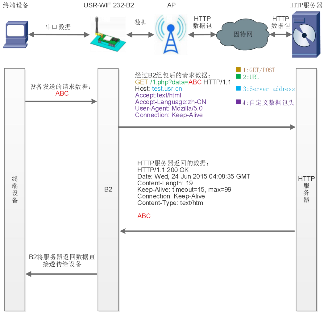
图 20 HTTPD Client 功能框图
