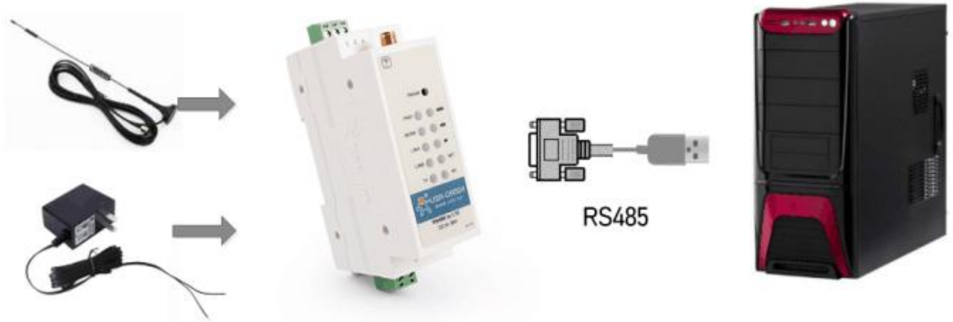
图 2 硬件连接示意图 (DR514 为 220V 接线端子供电, 无适配器)
