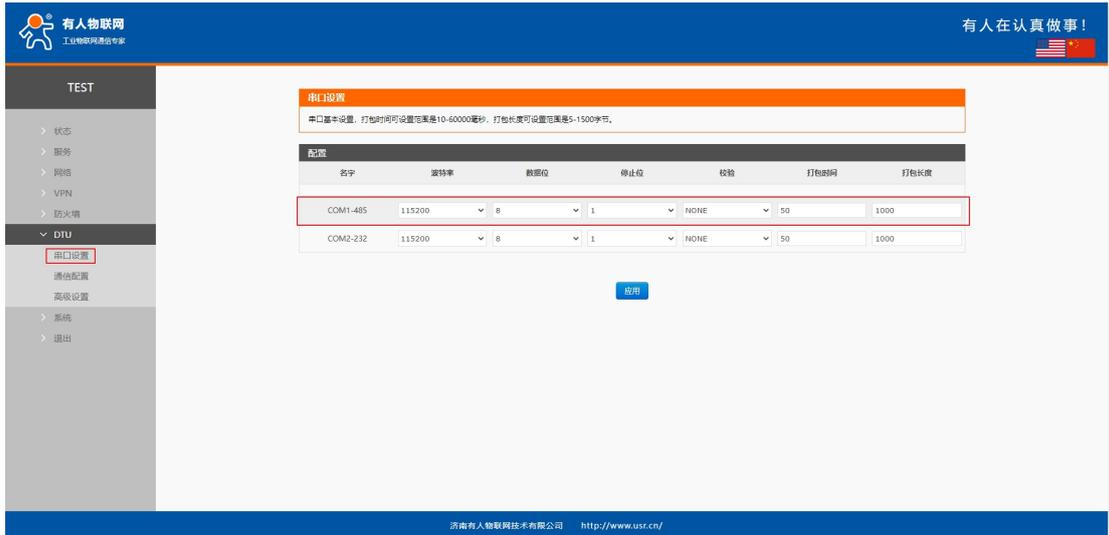
使用串口调试助手设置相对应的波特率等信息，点击打开，如图红色按钮代表打开串口成功
