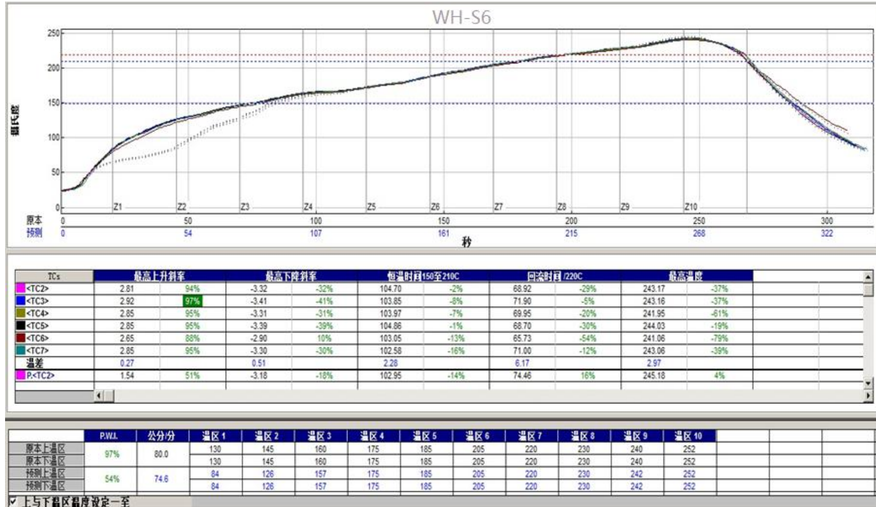
图 46：模块推荐焊接炉温曲线图
