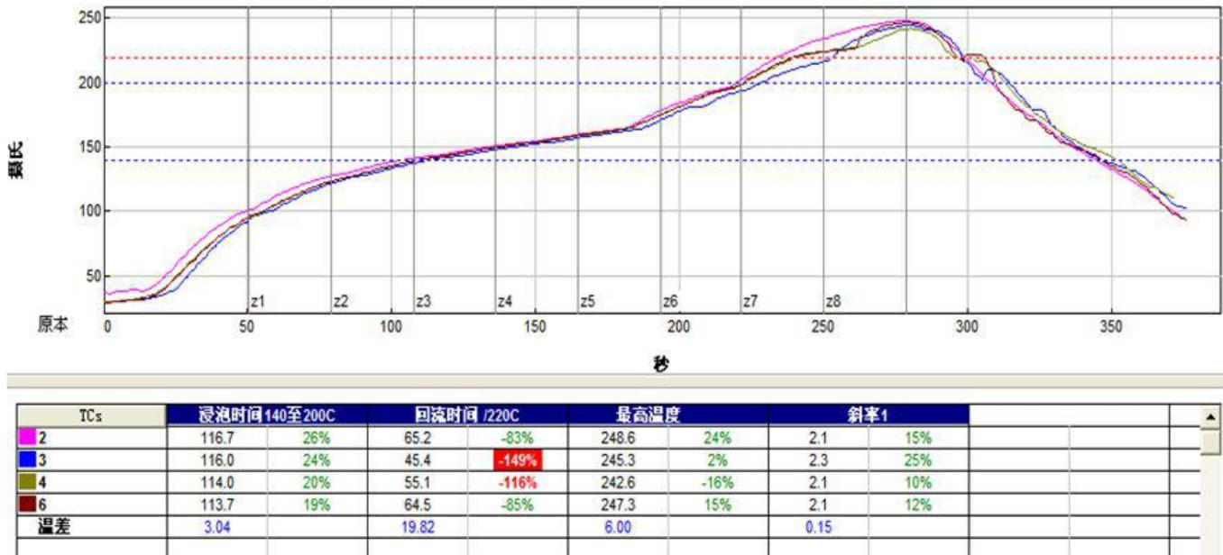
图片 6 回流焊焊接温度曲线图
