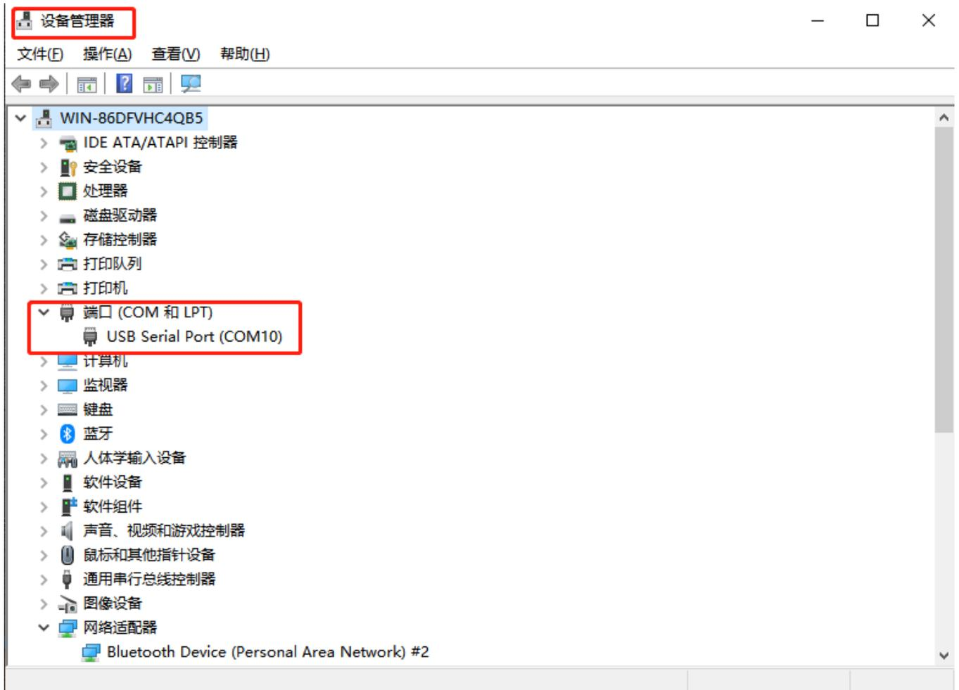
打开串口后，先点击进入配置状态，如果模块能返回+ok 的字符，说明电脑和模块连接是没有问题的；然后点击进入通讯状态，做数据通讯测试。
