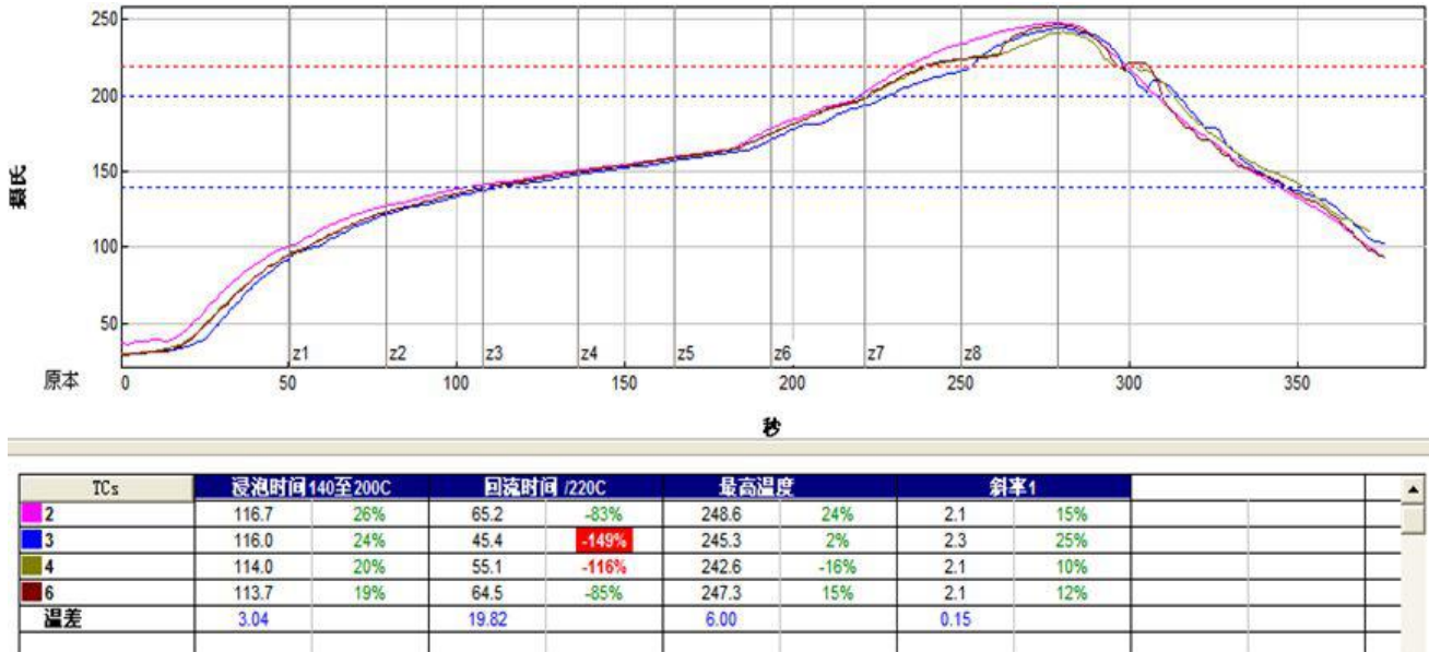
图片20 回流焊焊接温度曲线图
