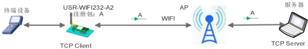
图 34 首次连接发送注册包框图
