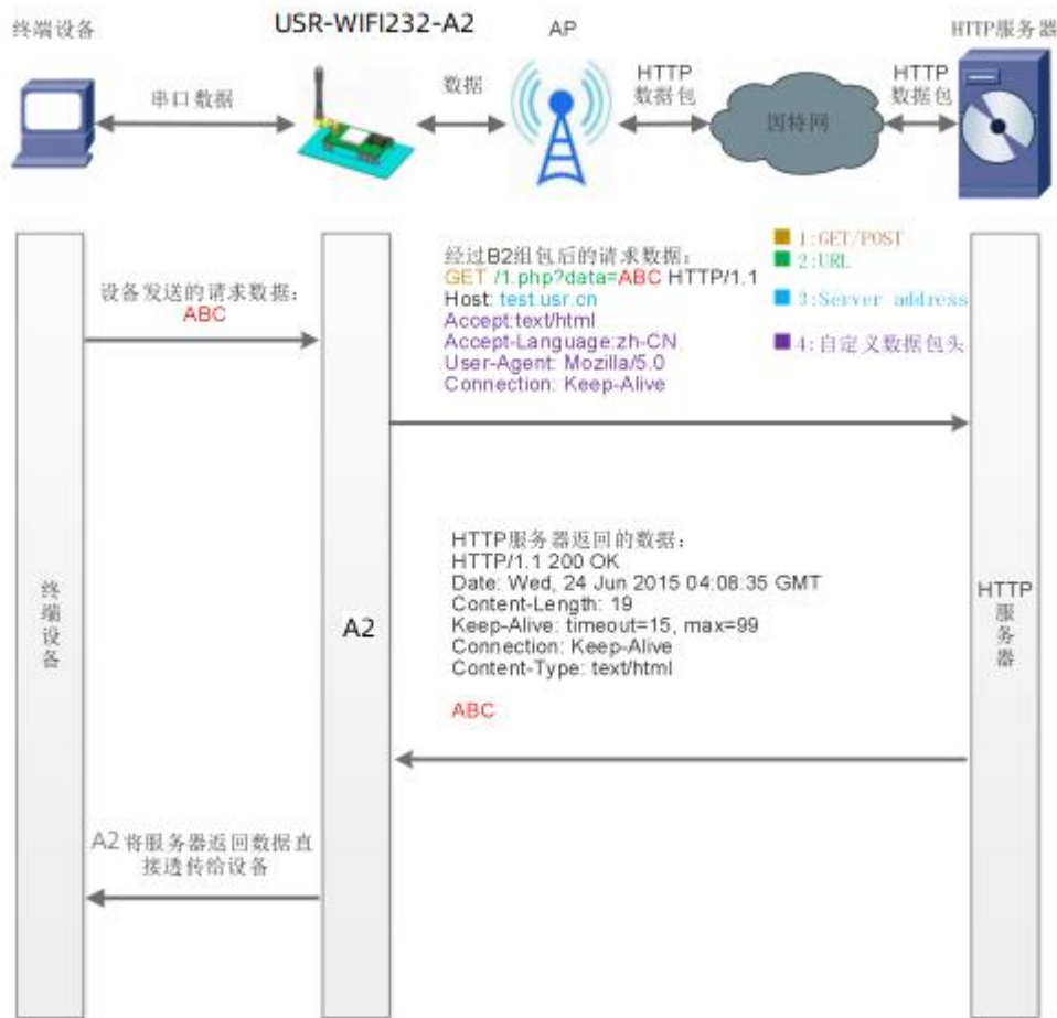
图 24 HTTPD Client 功能框图
